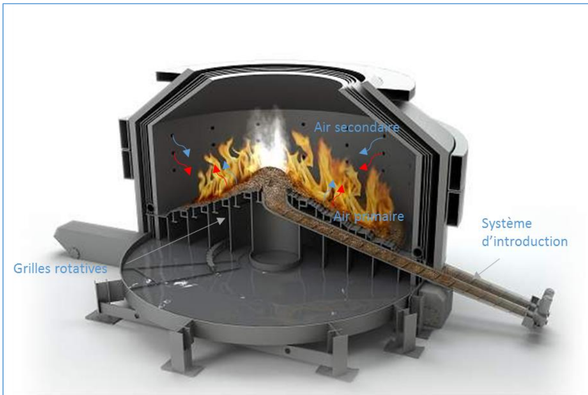
Figure 1.5. Schéma d'une installation volcan à grille rotative [43]
